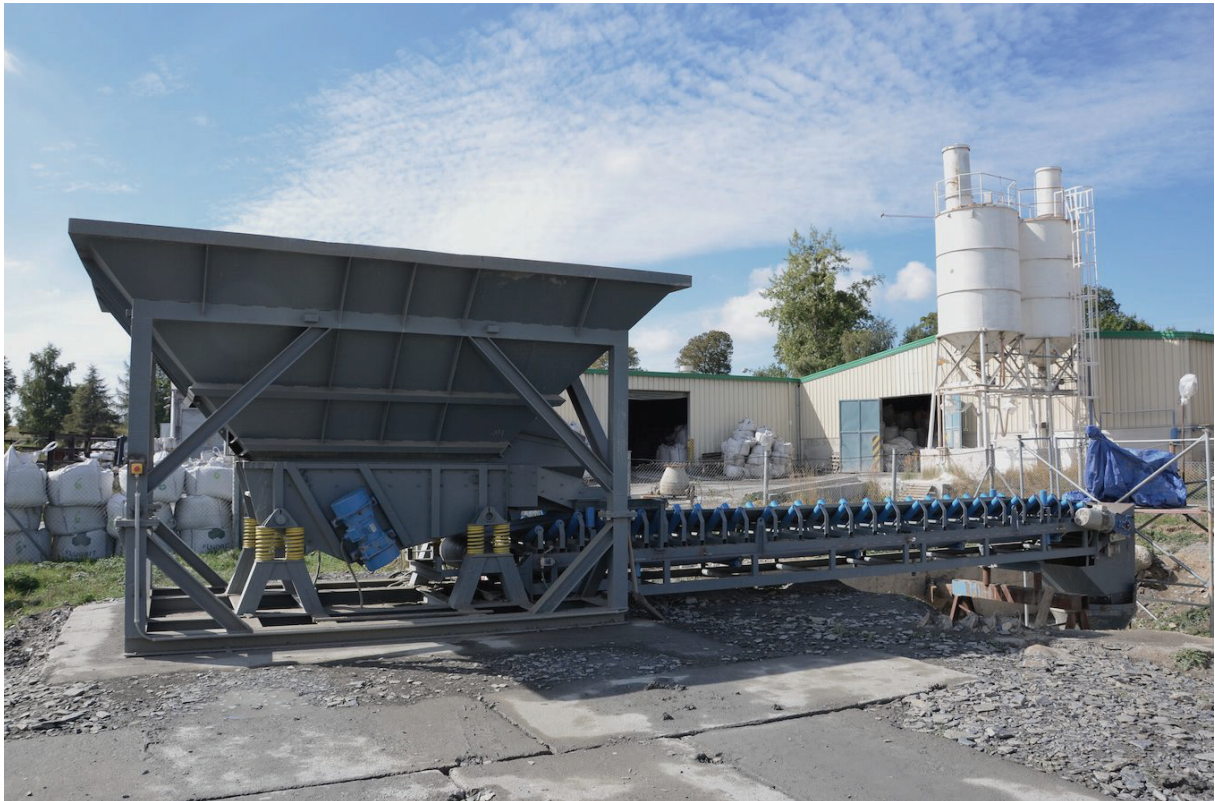
NJJ - vibrační zásobník s dopravním pásem a násypkou na ohlubni.
